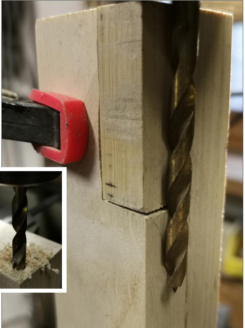
Im nächsten Arbeitsschritt werden die Stäbchen so abgerundet, dass eine störungsfreie Bewegung beim Öffnen bzw. Schließen des Deckels gewährleistet ist. Ein Halbkreis im Querschnitt ermöglicht einen Öffnungswinkel von 180°, bei einem Viertelkreis-Stab kann der Deckel nur um 90° geöffnet werden.
