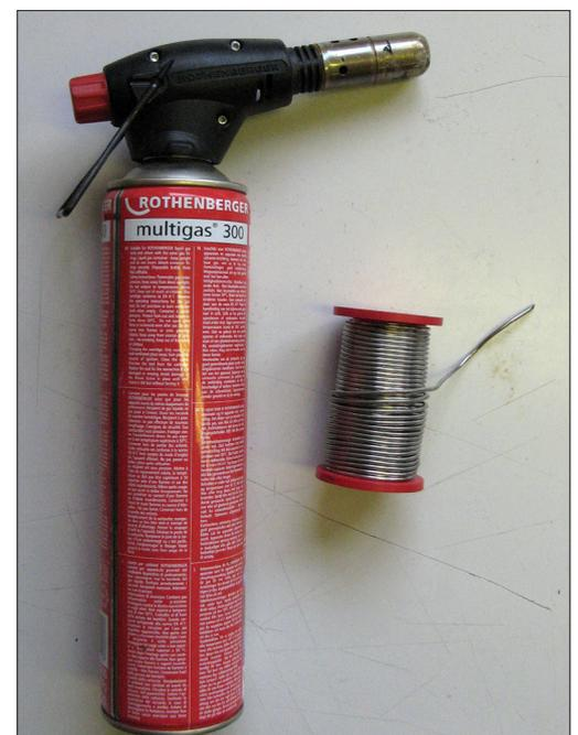
Die Lötstelle muss gleichmäßig erhitzt sein, so dass das Lot sofort in den Spalt schießt.
