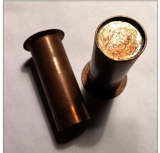
Beim Windrad wirken Hebelkräfte, deshalb sind Steckverbindungen hergestellt worden, die durch das Lot lediglich fixiert werden.
