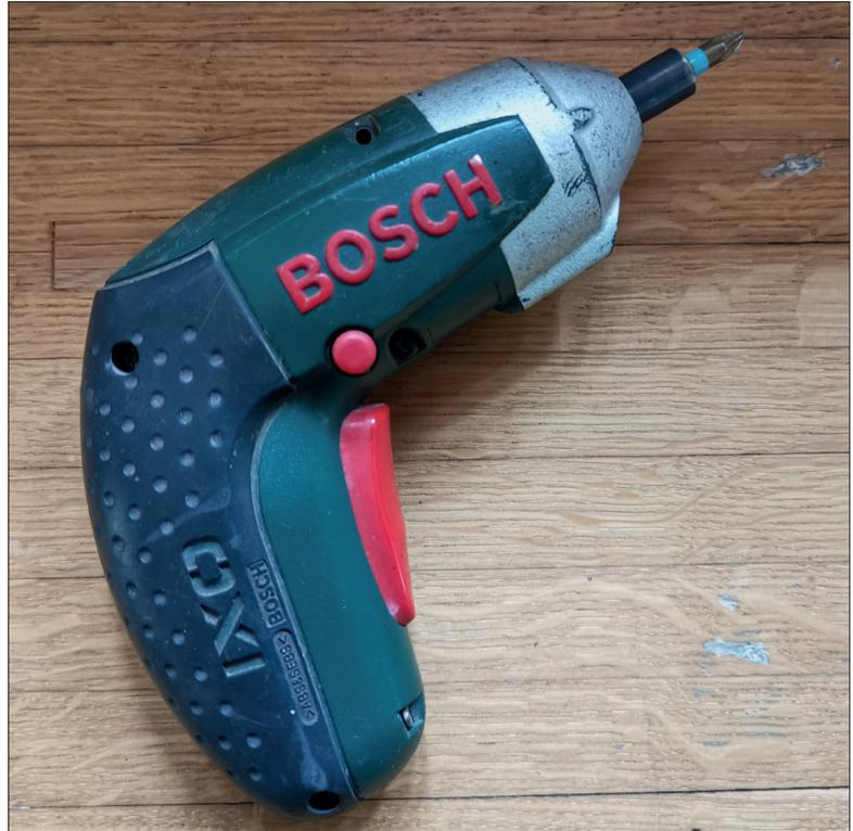
Man kann mit Bohrerbits bohren bis zu einem Durchmesser von 5 mm (Holz, Kunststoff, Gips) oder mit einer Schneidevorrichtung Karton, PVC oder Stoff bis 6 mm Stärke trennen. Es gibt für das neueste Modell dieser Art sogar Aufsätze, die als Korkenzieher dienen oder als Gebläse Grillkohle anfachen - sicher ein Grund für die Werbebezeichnung „Allround-Haushaltshelfer“.
